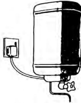
الشكل (16.1) خزان مسخن الماء فوق المغسلة
